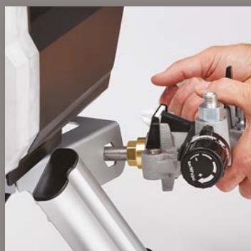
3. VYJMĚTE PATRONU POMOCÍ RÁMU
