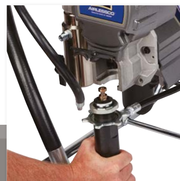
2. ZDVIHNĚTE DVÍŘKA A VYJMĚTE ČERPADLO
