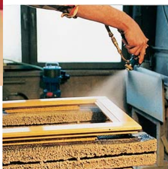
Nanášení nátěru na dřevěné okenní rámy systémem Air Combi
