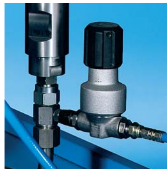
Zpětný ventil zajišťuje konstantní teplotu stříkaného materiálu při použití verze Hot Spray s cirkulačním systémem.
